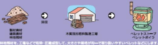
薪材や林地残材を、工場などで粉砕・圧縮成型して、大きさまや規格が均一で取り扱いやすいペレットなどにします。
