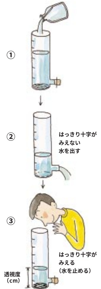
図－1 透視度の測定方法
